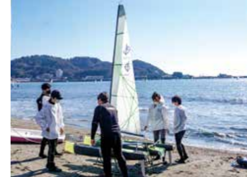
platform ZUSHI BIZの登録企業による逗子海岸での自動操船ヨットの走行実験
