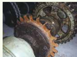
浄水管理センターの摩耗した機械部品
