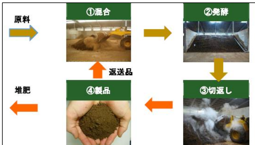
図8 発酵処理の流れ ※葉山町受託事業者が作成した「葉山町クリーンセンター再整備工事技術提案書類」による
