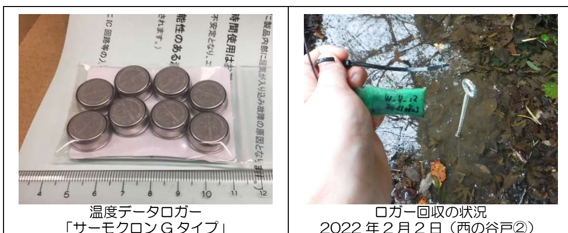
写真 2-11 温度データロガーによる水温調査
