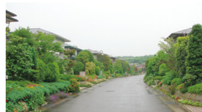
湘南国際村の例。道路幅6m、建築壁面後退3m、緑地帯2m、電線地中化、閉鎖的な塀の禁止などが行われている
