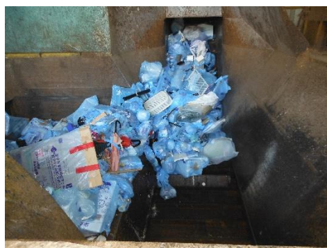
不燃ごみ処理の状況（破碎施設投入口）
