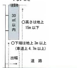
○壁面突出広告物の出幅は、建築物から 1.2m 以下で、路端から 1m 以下
