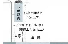
○壁面突出広告物の出幅は、建築物から 1.2m 以下で、路端から 1m 以下
