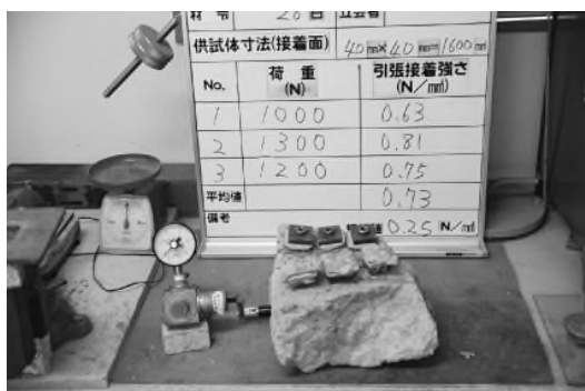
写真 4 - 4 - 4 3 引張接着強さ試験状況 (注入モルタル)
