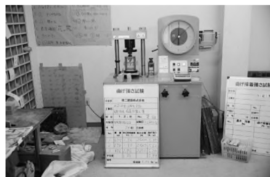
写真 4 - 4 - 4 4 曲げ強さ試験状況 (注入モルタル)
