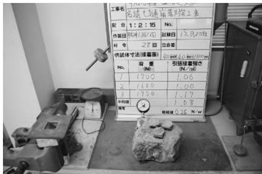
写真 4 - 4 - 4 0 引張接着強さ試験状況 (目地モルタル)
