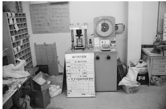
写真 4 - 4 - 4 1 曲げ強さ試験状況 (目地モルタル)
