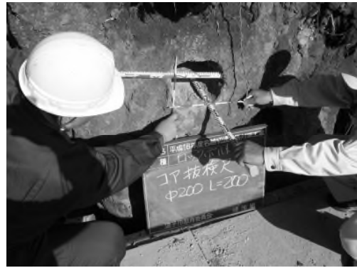
写真4-4-3 コア寸法検尺（サイトF） （径 200mm、深さ 200mm）
