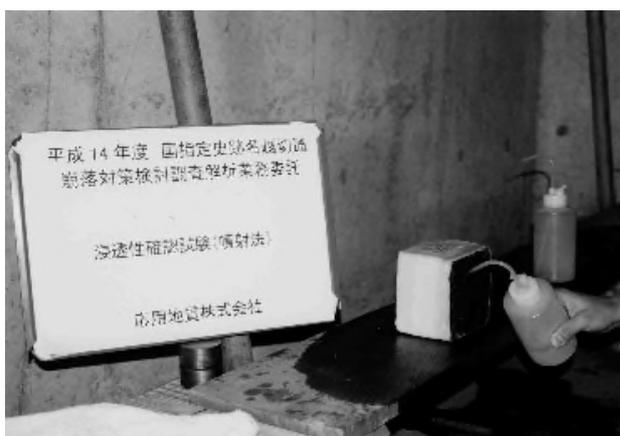
写真3-5-4 洗瓶法による室内試験
