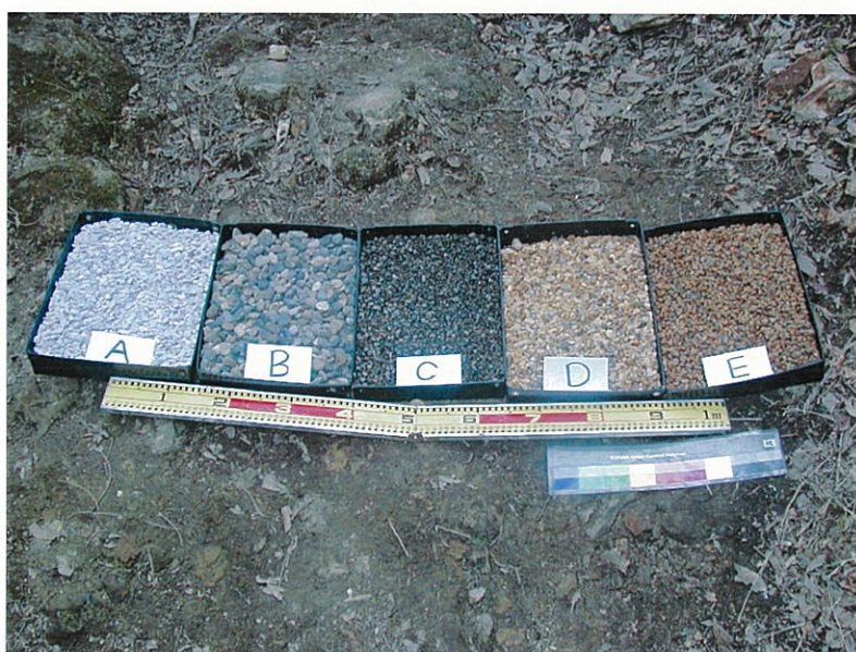
敷砂利状況－ 2 (通路内での色調比較)
