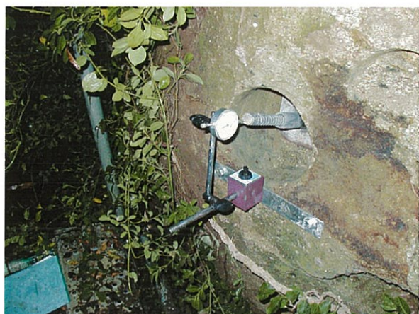
写真 5－3－6 引き抜き試験状況
