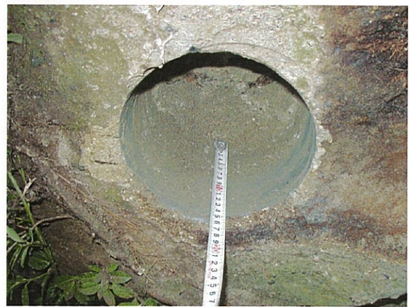
写真 5－3－2 頭部コア抜き（径20cm 深さ20cm）
