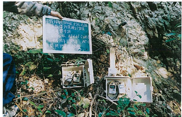
水分計・岩盤温度計 データ回収状況（北側）
