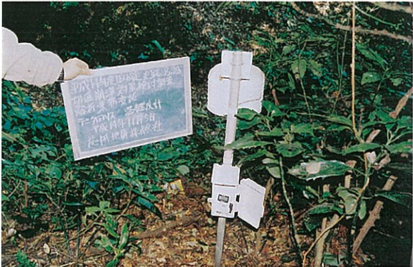
温湿度計 データ回収状況
