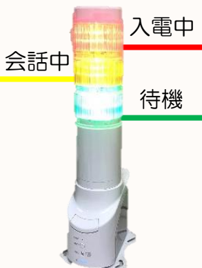
消防側通信機器
